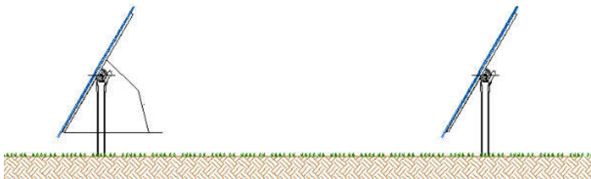
Figura 3.1 - Estruturas de suporte para painéis fotovoltaicos
